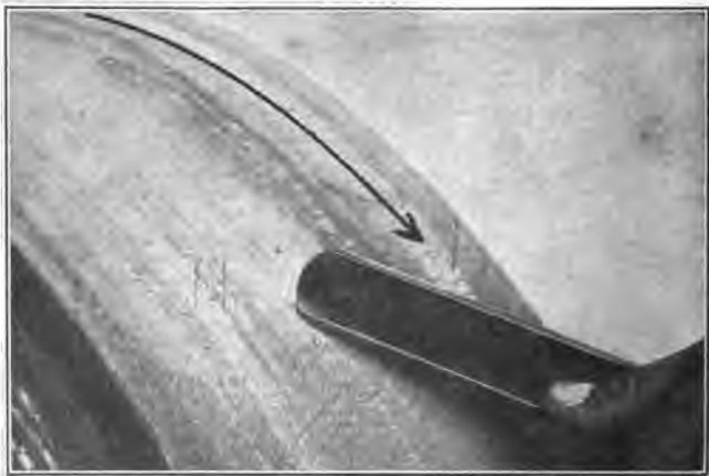
Fig. 284. Grinding a Gouge.
